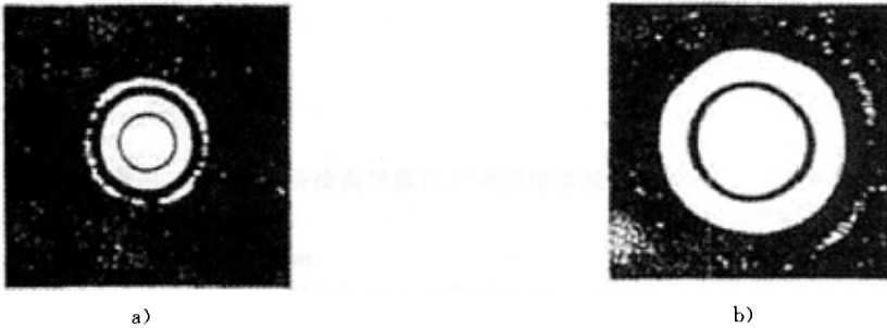
图1 两种球形粒子的散射图(a 颗粒粒径为 b 颗粒的 2 倍)
